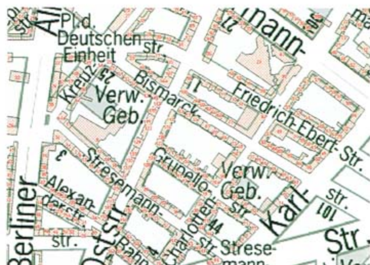
Abb. 1: Überlagerung der Stadtgrundkarte (rot) mit der Stadtkarte (grau) in der Düsseldorfer Innenstadt.
